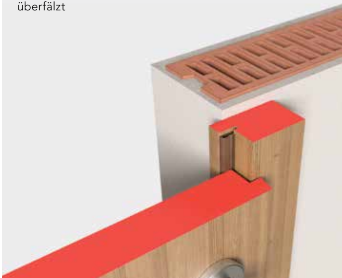
Pfostenstock Typ Vinschgau, (mit Schattenfuge) überfälzt
